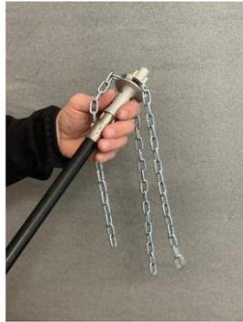
Keramische und Metallfänge werden mit den Fäden und Stahlseilen vom Hartrußbelag befreit.
