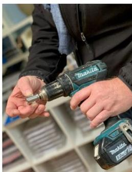
**ACHTUNG:** Der Akku-Bohrschrauber ist erst dann in Betrieb zu nehmen, wenn sich der Reinigungskopf im Kehrgegenstand befindet.
