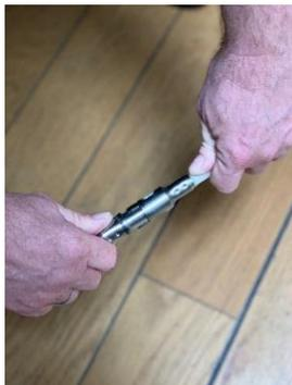
Die Stangen werden je nach Bedarf zusammengesteckt - erst die dünneren, dann die stärkeren Stangen. Die stärkeren Stangen geben Halt, die dünneren Stangen sind flexibel.
