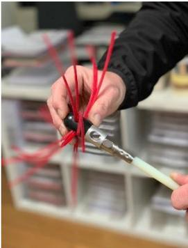
Die Reinigungsköpfe werden mit der Doppelkupplung am Stangeneende montiert. Je nach Einsatzgebiet werden die entsprechenden Köpfe aufgesetzt.
